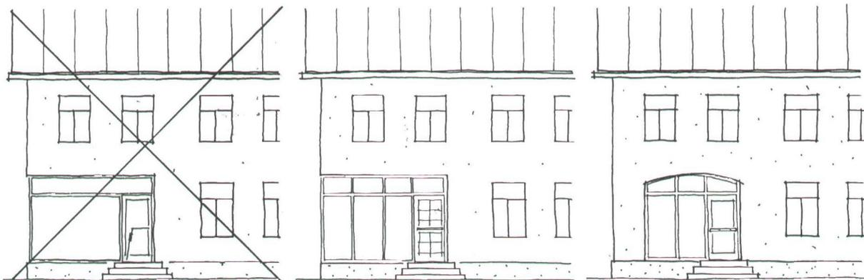
Insbesondere bei offenem Fachwerk müssen sich Fassadenöffnungen dem konstruktiven Holzwerk unterordnen.
